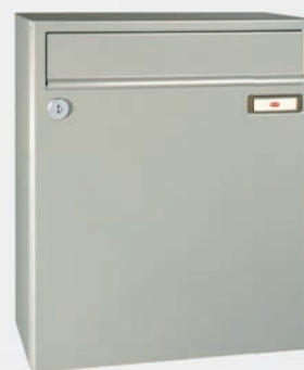
Format 370 x 440 x 145 mm, avec entrée oblique RS50 , clapet à lettres de 335 x 50 mm, verrouillage à 2 points
